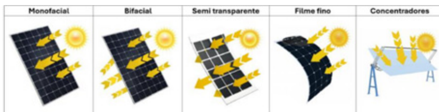
Figura 2. Tipo de tecnologia de painéis fotovoltaicos utilizadas nos sistemas agrofotovoltaicos
